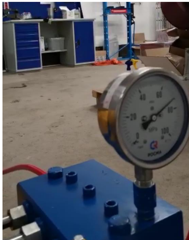
Рис.5 Замер перепада давлений на шаре
