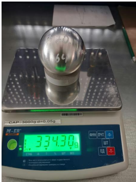
Рис.1 Шар 70,00 мм перед началом испытаний
