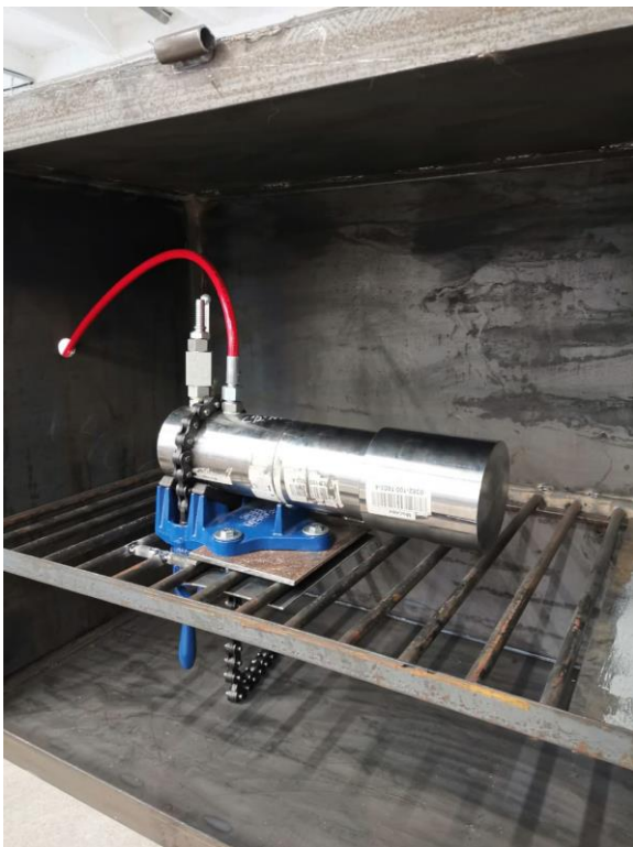
Рис.4 Стенд для опрессовки шара
