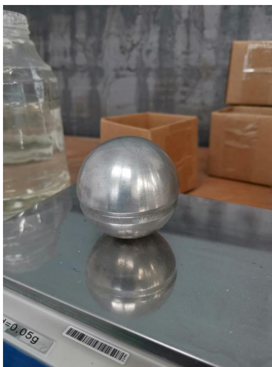
Рис.6 Шар после испытаний на перепад давлений
