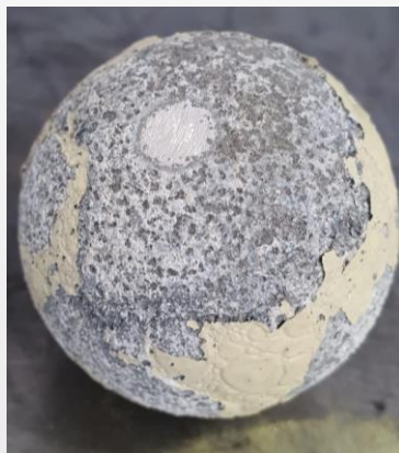
Рис.2 Шар спустя 12 часов после начала растворения
